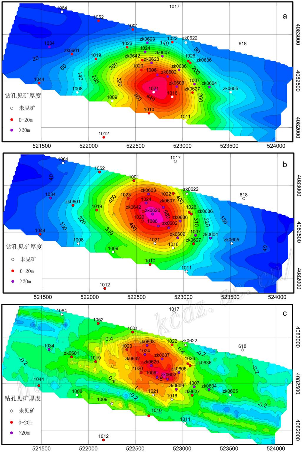
图 2 白涧铁矿矿区高精度磁测成果
