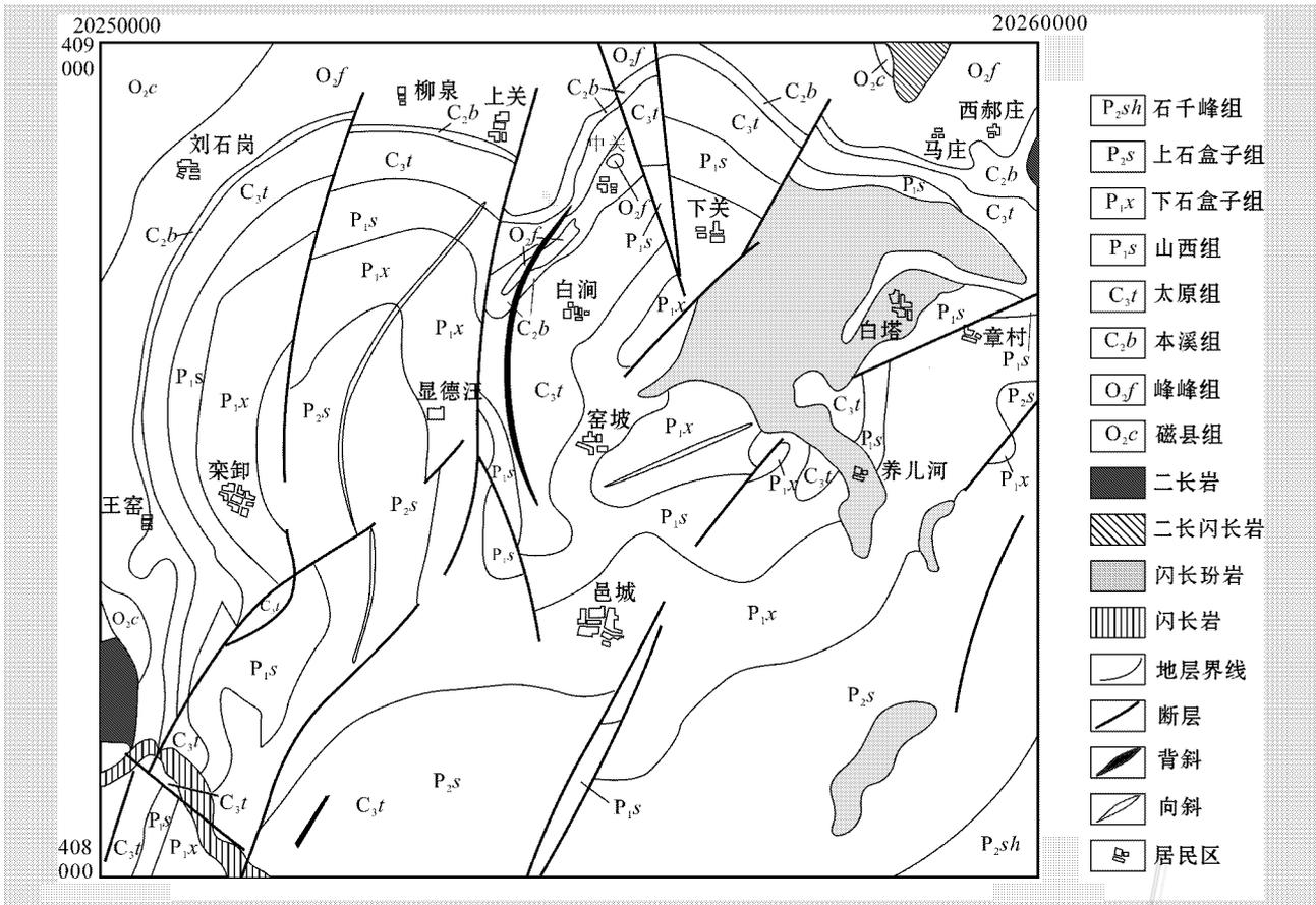
图 1 白涧铁矿床地质简图(据河北省地勘局第十一地质大队 2008<sup>①</sup>简化)
