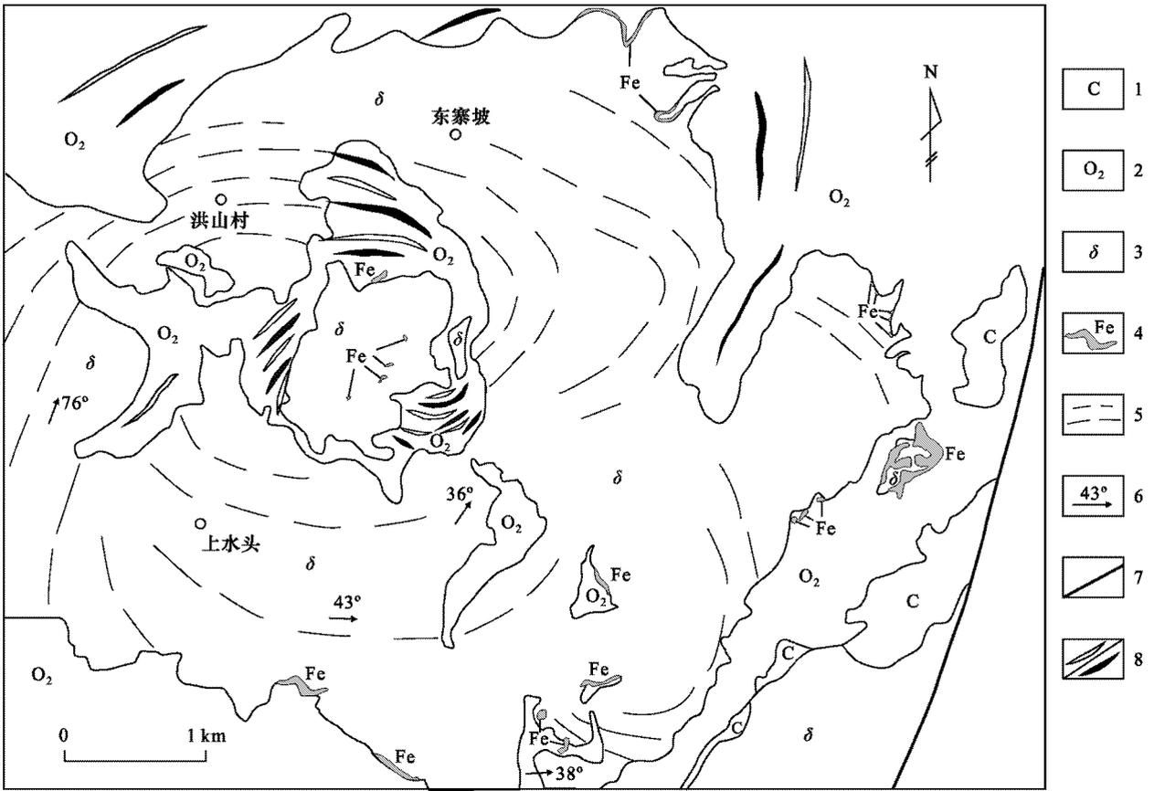
图 4 矿山村矿区岩体侵位构造示意图(据华北地质科学研究所等资料<sup>①</sup>)
