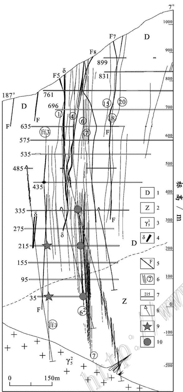
图3 盘古山钨铋矿床20号勘探线剖面简图及采样位置①
