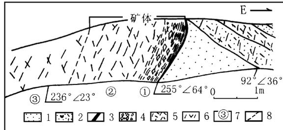
图2 砂宝斯金矿区III号矿体及蚀变带
