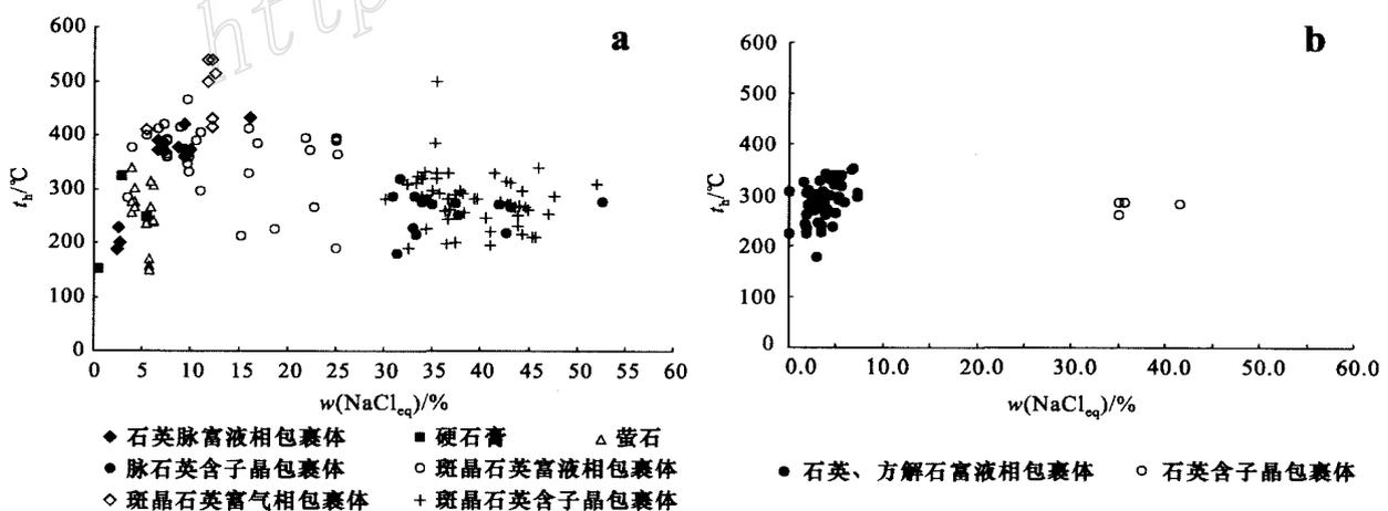
图3 驱龙斑岩铜矿(a)和知不拉矽卡岩铜矿(b)流体包裹体均一温度-盐度图(据李光明等,2003<sup>①</sup>;杨志明等,2005资料整理)
