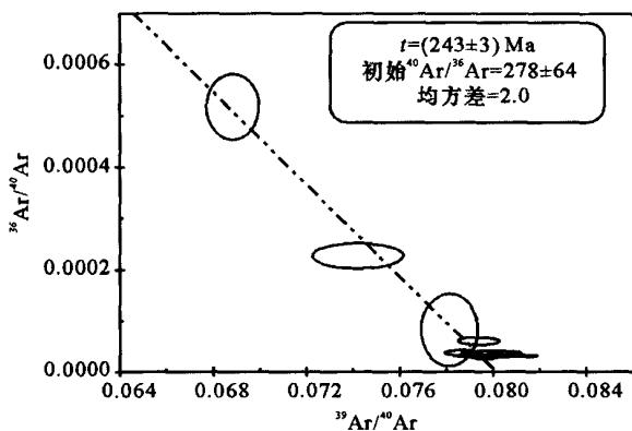
图 5 镜儿泉伟晶岩型稀有金属矿床中白云母的 $^{40}\text{Ar}/^{39}\text{Ar}$ 反等时线
