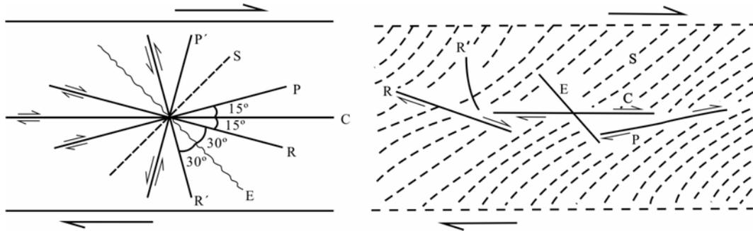
图7 Reidel简单剪切系统模式图(邓军, 1998)
