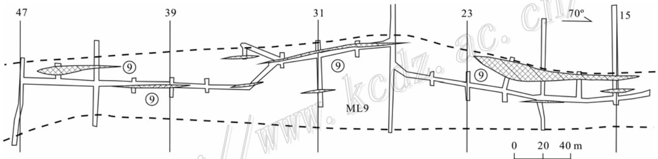
图 12 云西矿床-140 m 中段透镜状矿体
