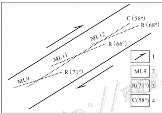
图 9 广宁-罗定韧性剪切带在河台矿区的 C-R 次级构造控矿模式
