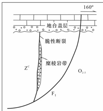
图 10 糜棱岩带中第三级构造裂隙与 F<sub>1</sub> 断裂连通形成“y”字形构造控矿系统（刘伟等，2006）
