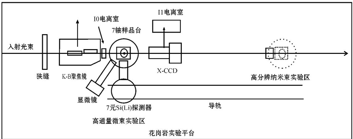
图5 同步辐射 X 射线荧光实验站布局图
