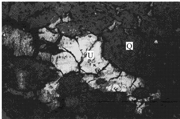
图 6 玉髓脉中的脉状沥青铀矿(微脉状构造)
