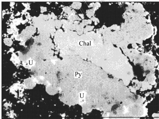
图 4 块状黄铁矿与黄铁矿中的粒状沥青铀矿(微粒结构)
