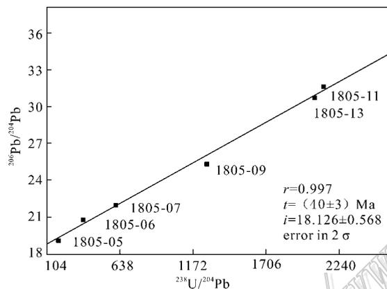
图 13 热叠造铀矿石 U-Pb 等时线年龄图解
