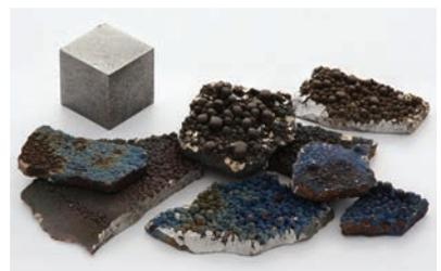
图3 锰立方体与在空气中氧化后的电解精炼锰
